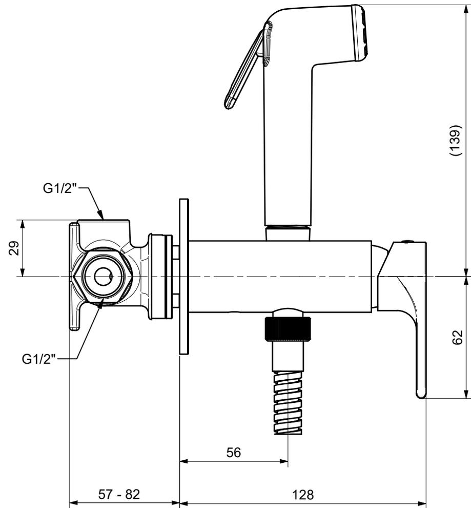
Monocomando per idroscopino con stop SIMPLE
