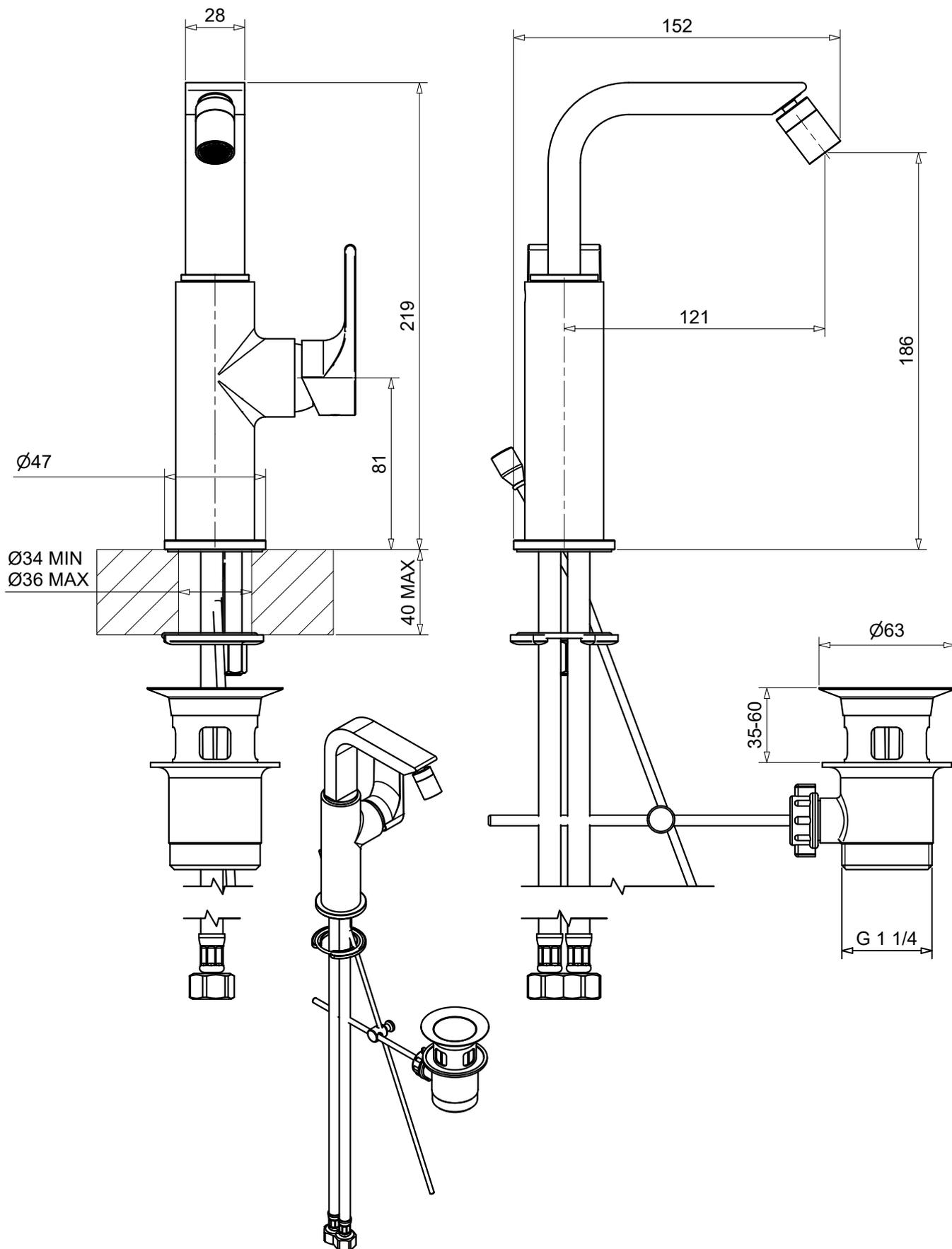
Monocomando bidet scarico automatico 1"1/4 con flex inox.
