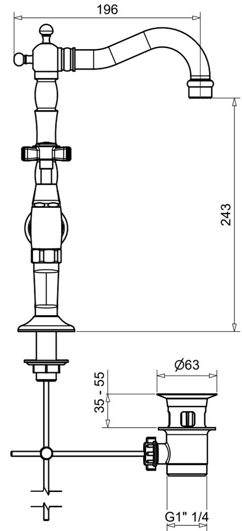
Batteria lavabo a ponte con scarico automatico 1" 1/4 Princeton
