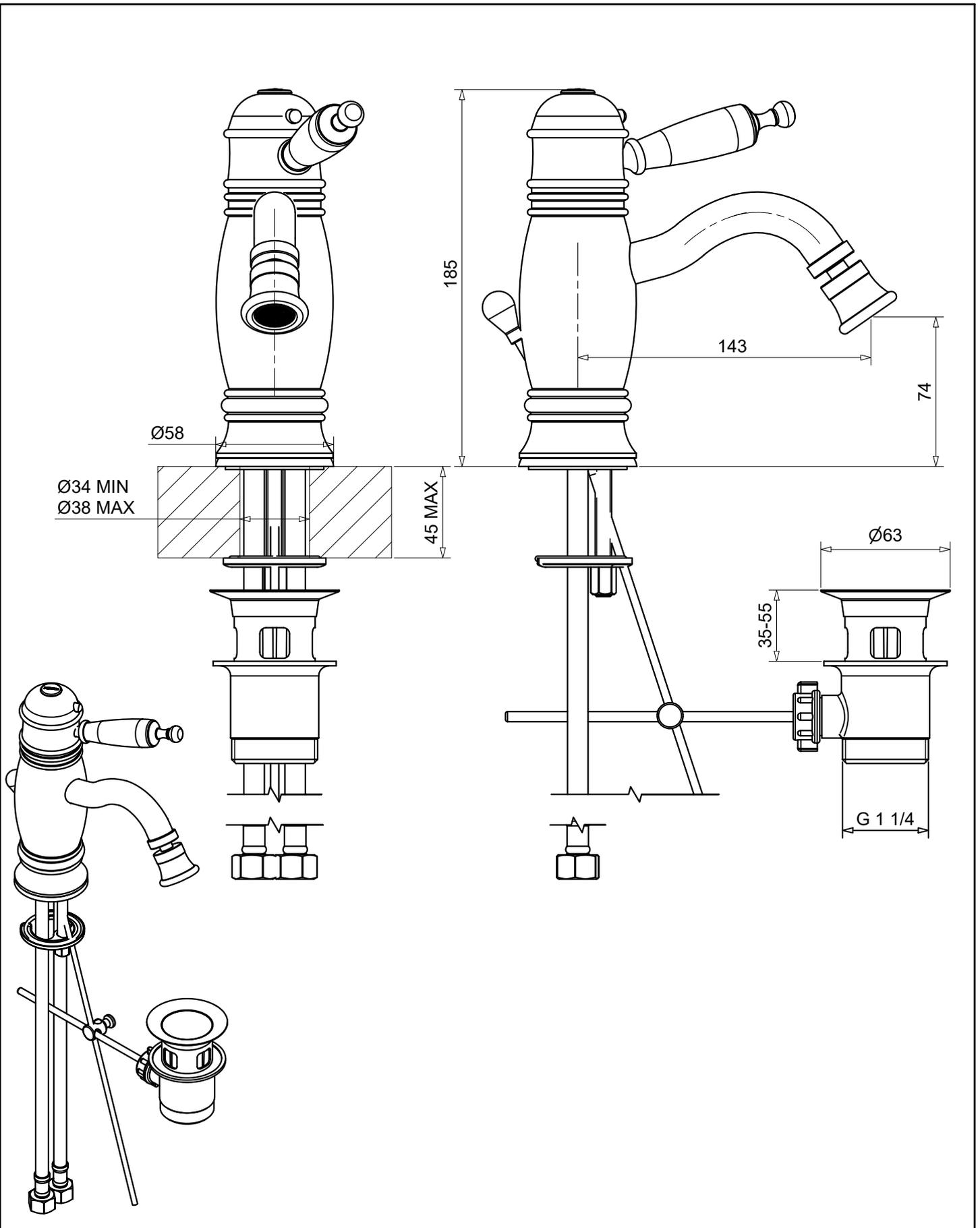
Monocomando bidet termostatico con scarico automatico 1"1/4 flex inox
