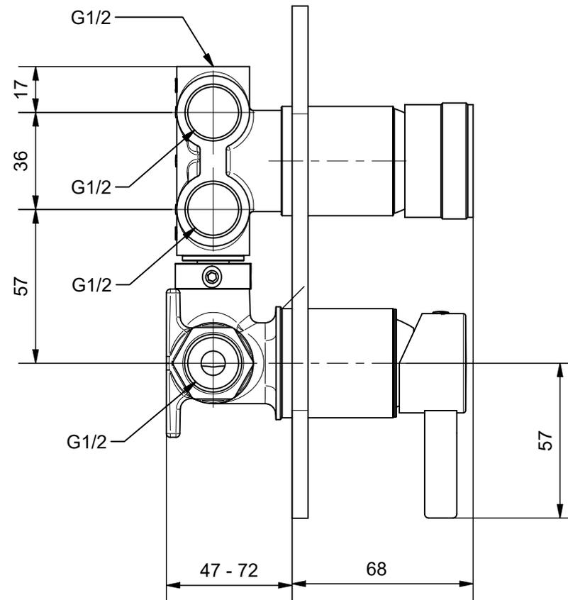
**Monocomando incasso con deviatore a 4 uscite ORION**
