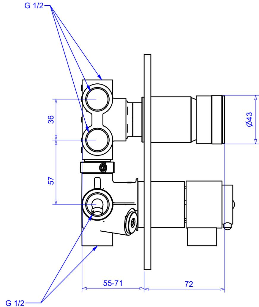
Monocomando incasso termostatico con deviatore a 4 uscite STONE
