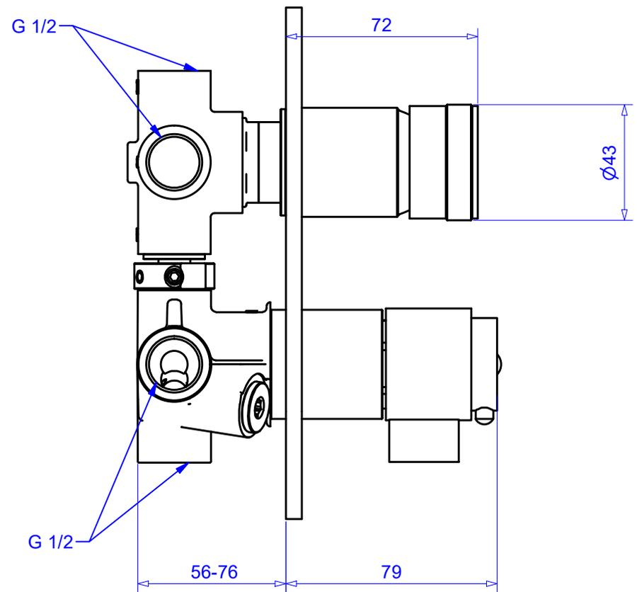
Monocomando incasso con deviatore a 3 uscite KOBUK
