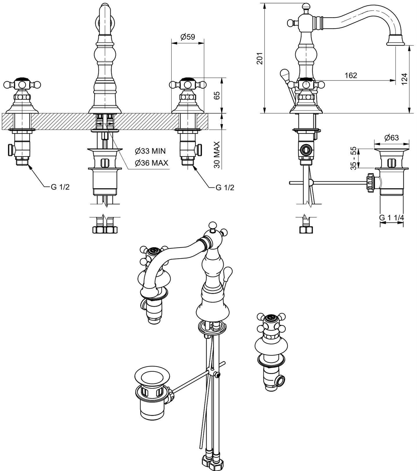
Batteria lavabo scarico automatico 1"1/4
