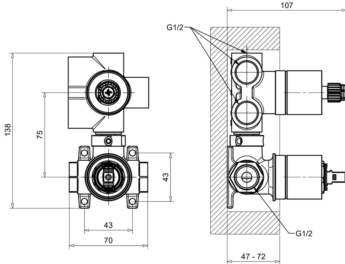
Incasso per monocomando con deviatore manuale a 4 uscite
