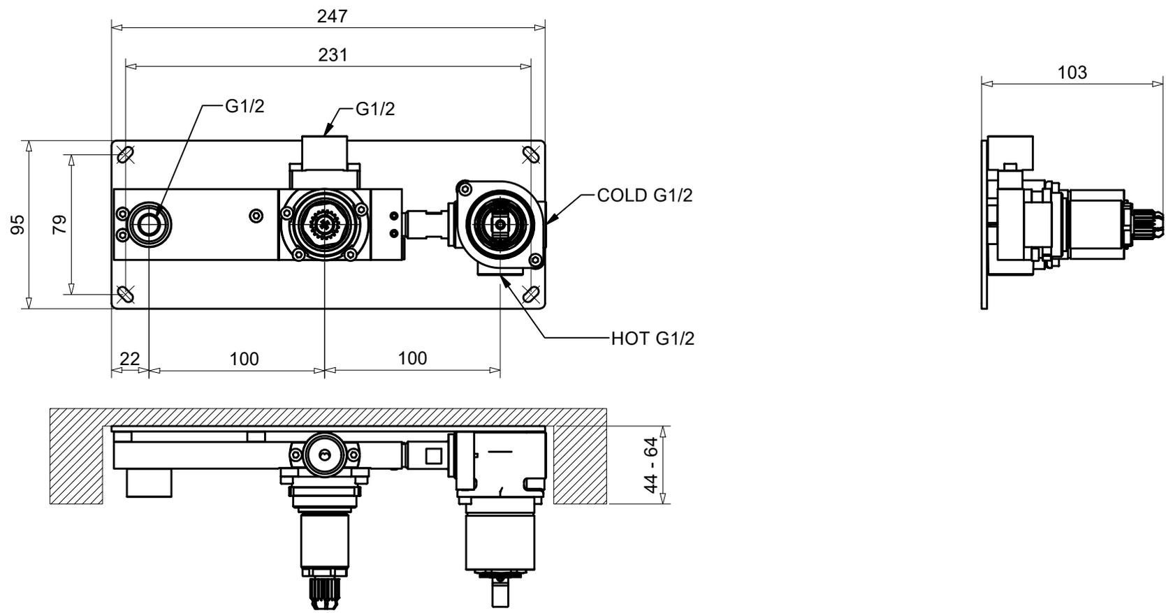
Blocco incasso per monocomando con soffione e kit duplex
